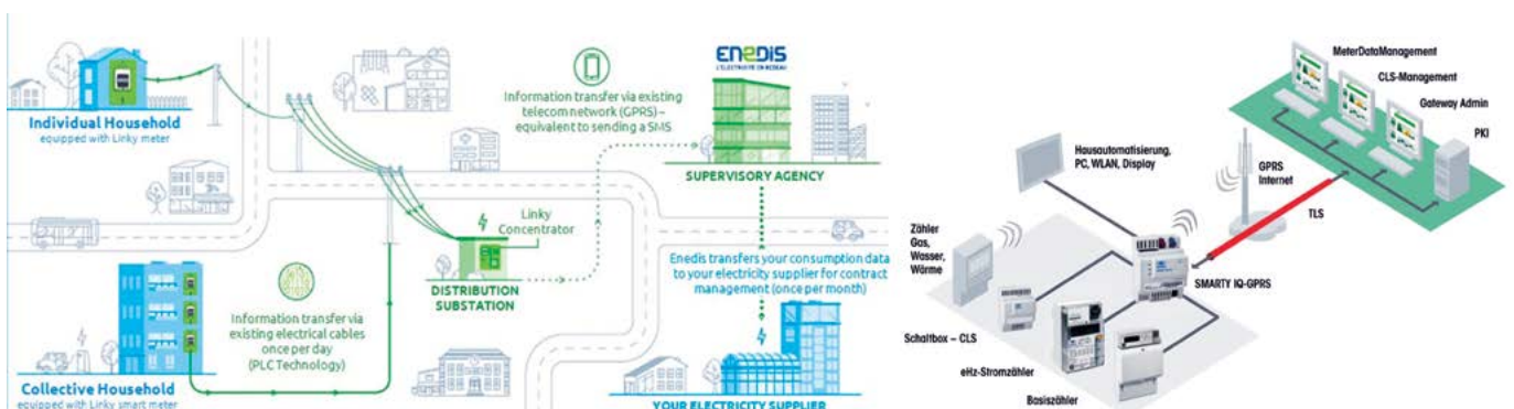
Abb. 1: Enedis DSO und dt. SMGW SMARTY IQ-LTE- Architekturvergleich
